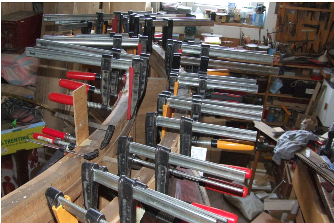
Snímek 68: Lepení dýh podstavce – průběh restaurování
