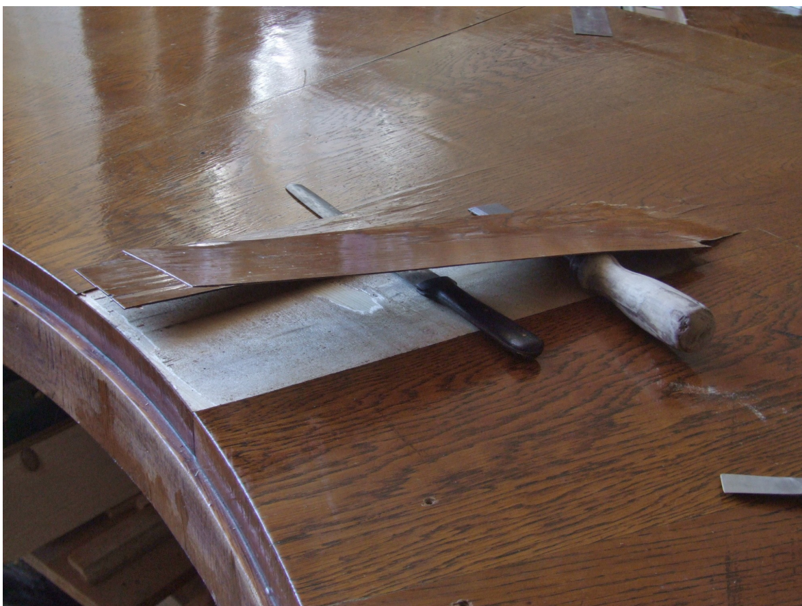
Snímek 71: Uvolněná dýha stolu – průběh restaurování
