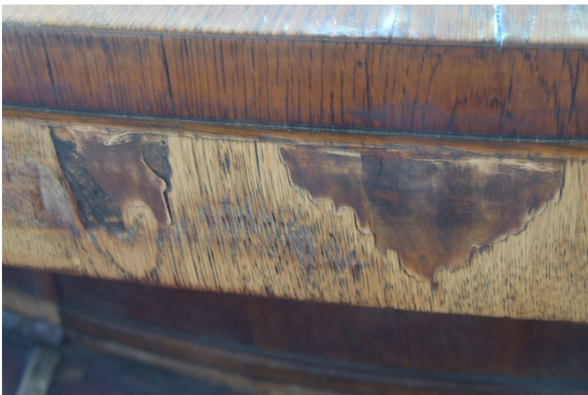
Snímek 9: Hrana stolové desky s utrženou dýhou – před restaurováním
