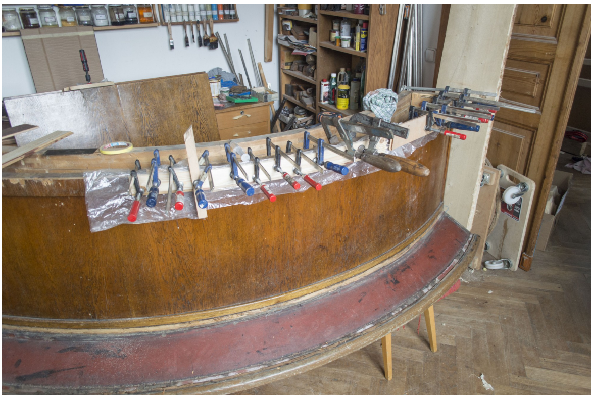
Snímek 70: Lepení dýh podstavce – průběh restaurování
