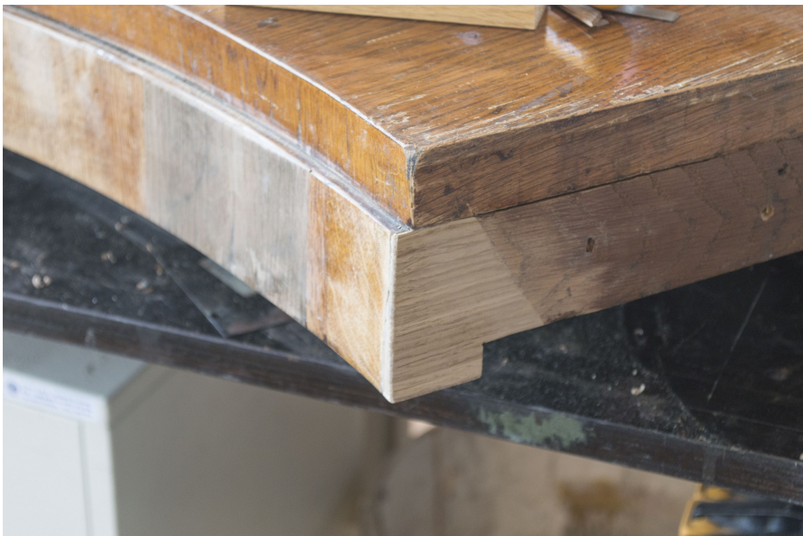
Snímek 72: Opravené dýhy stolu – průběh restaurování
