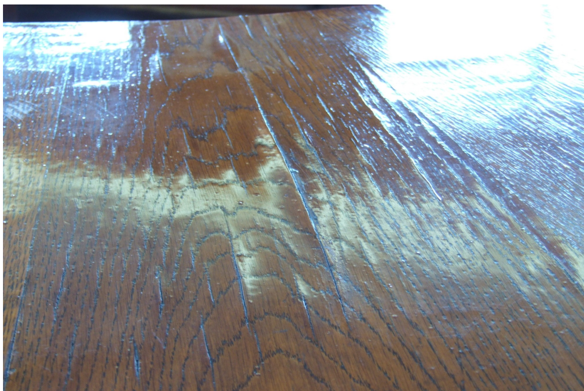
Snímek 7: Detail zvlhčené dýhy na stolové desce – před restaurováním
