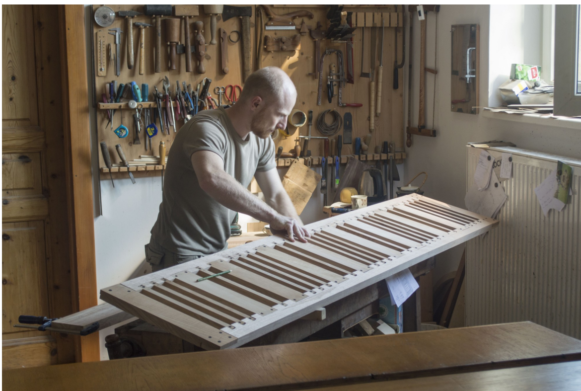
Snímek 85: Výroba nových částí k větracím šachtám
